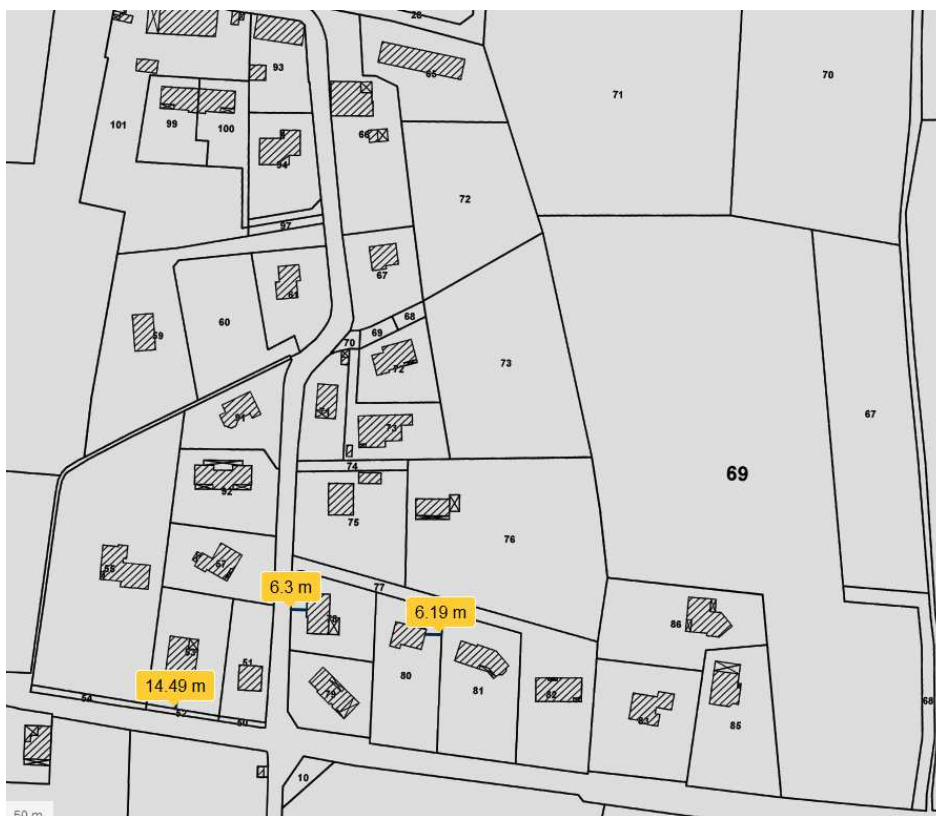
Figure 34. Exemple de distances entre les bâtiments existants et les limites de référence et séparatives Le Gay Est. Source : Géoportail 2017 et 2BR.
